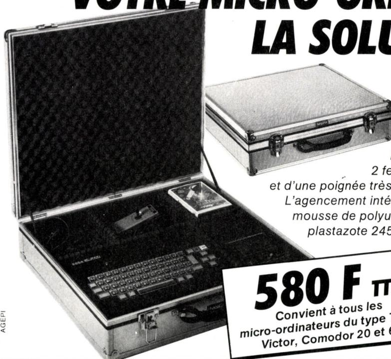
Mallette réalisée en contre-plaqué 4 mm recouvert d'aluminium pointe de diamant, renforcée par un cadre en aluminium et par 8 coins métalliques, lui assurant une très grande robustesse.
